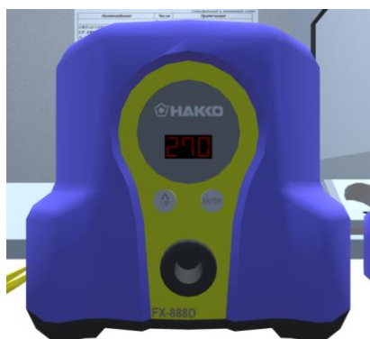
Рис. 7. Установка температуры пайки
