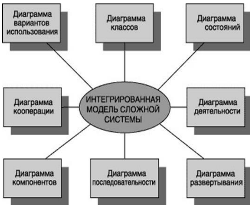
Рис. 1. Интегрированная модель САС в нотации UML-моделей
