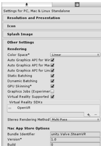
Рис. 1. Настройки проекта Unity под виртуальные очки: включена опция VirtualRealitySupported, в списке SDK имеется плагин OpenVR
