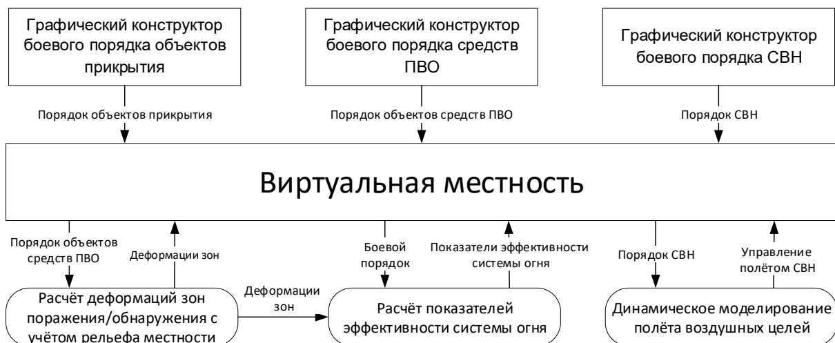
Рис. 4. Структурная схема виртуального полигона
