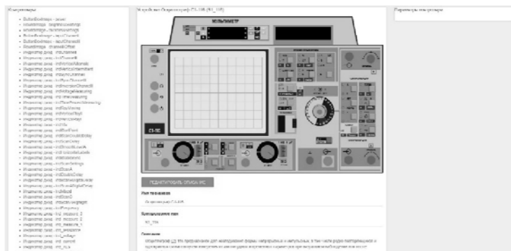
Рис. 3. Интерфейс размещения и моделирования органов управления виртуального приборного тренажёра
